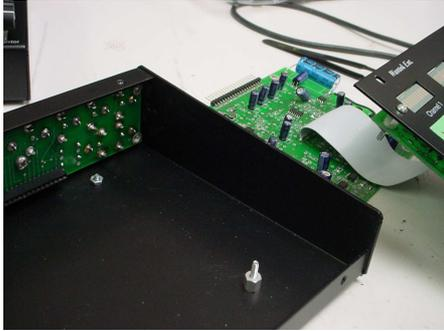
Remonter la carte arrière dans le boîtier avec ses cinq vis. Branchez la plaque principale dans la plaque arrière avec le connecteur multibroches, et sécuriser la carte principale sur le fond du boîtier avec ses vis. Assurez-vous d'utiliser les entretoises pour tenir la carte principale en place.
