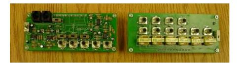
La carte ci-dessus à gauche est tournée vers l'extérieur à l'arrière de la console. Les interrupteurs, les prises, et les ajustements sont accessibles à travers de trous percés dans la console. La carte à droite face vers l'intérieur de la console, est disposée des connexions internes, et relie tout l'audio au mélangeur. Sur le côté droit de cette carte est un petit disjoncteur.
